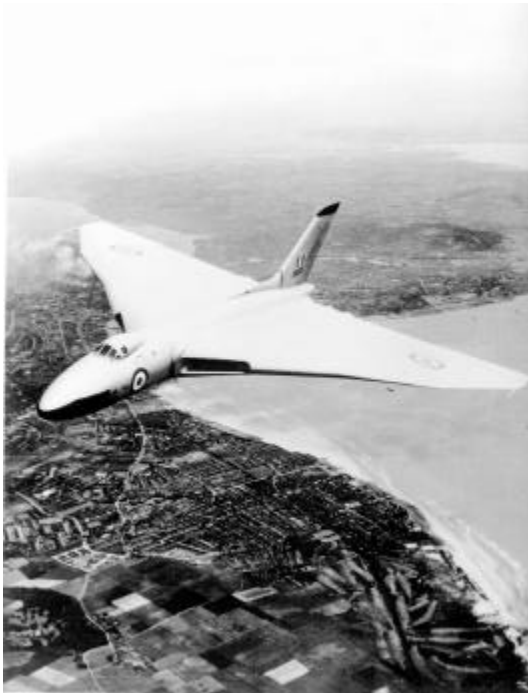
Mis à l'étude en Grande-Bretagne dès 1946, l'Avro « Vulcan » fait partie des trois bombardiers à réaction commandés au début des années cinquante. Une centaine de cet appareil subsonique à aile delta ont été construits entre 1955 et 1959. Les derniers « Vulcan » ont été retirés du service en 1985.
